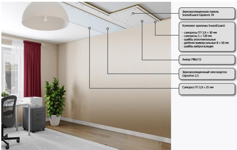
Gipslock – бескаркасное решение, основанное на применении комбинированной трехслойной панели Gipslock 70 и звукоизоляционного гипсокартонного листа SoundGuard Gipsophon. Применяется в многоквартирных и загородных домах, а также в нежилых помещениях. Индекс дополнительной звукоизоляции  $R_w$  16 – 19 дБ Толщина системы – 82,5
