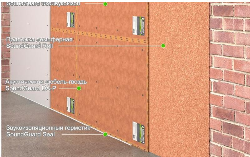
Материалы для бескаркасной звукоизоляции стены в квартире - система "Стандарт" RW = 58-60 дБ (1м2)
