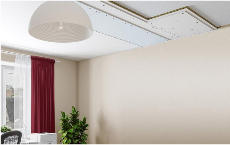
Gipslock – бескаркасное решение, основанное на применении комбинированной трехслойной панели Gipslock 120 и звукоизоляционного гипсокартонного листа SoundGuard Gipsophon. Применяется в многоквартирных и загородных домах, а также в нежилых помещениях. Индекс дополнительной звукоизоляции  $R_w$  16 – 19 дБ Толщина системы – 132,5 мм
