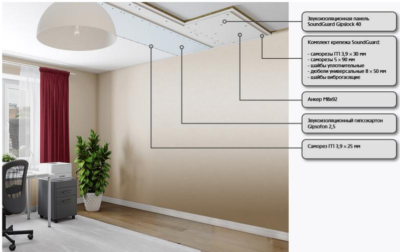
Gipslock – бескаркасное решение, основанное на применении комбинированной трехслойной панели Gipslock 40 и звукоизоляционного гипсокартонного листа SoundGuard Gipsophon. Применяется в многоквартирных и загородных домах, а также в нежилых помещениях.
