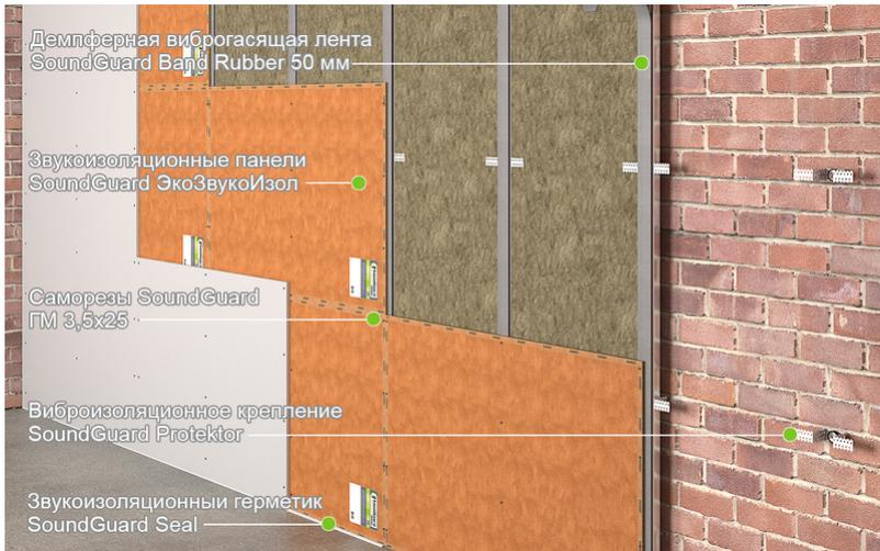
Каркасная звукоизоляция стены "Стандарт", RW = 64-66
