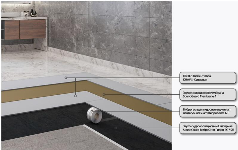
Система звукоизоляции пола под финишное покрытие для помещений с повышенным уровнем влажности. Имеет равные звукоизоляционные характеристики с системой «ОПТИМА». Отлично изолирует шум бытовых приборов, крики, лай собак, шаги, падение и передвижение предметов. Применяется в ванных и душевых комнатах, помещениях с бассейнами, саунах, и т.д. Толщина системы: 49,8 мм Индекс дополнительной звукоизоляции: L<sub>nw</sub> ~ 23 дБ
