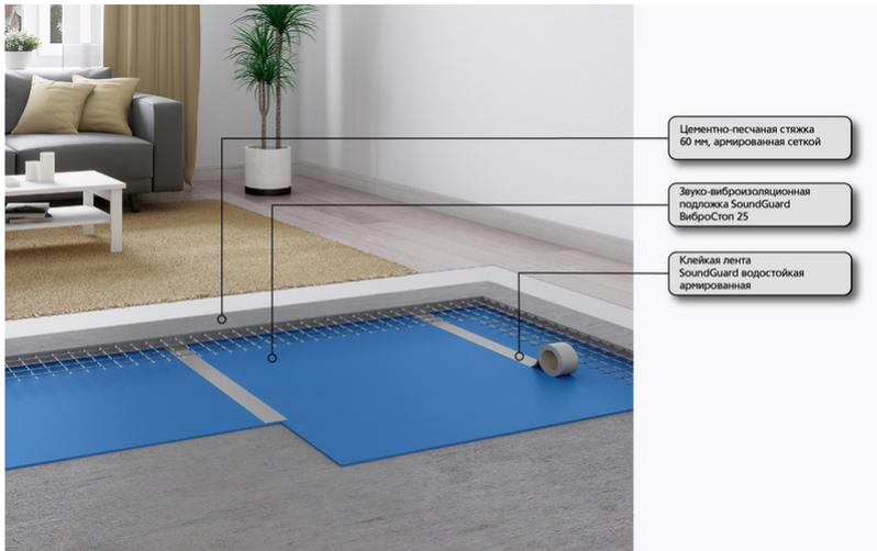
Самая тонкая система звукоизоляции пола под стяжку в линейке решений SoundGuard. Существенно снижает звуки бытовых приборов, плач ребёнка, лай собак, шаги, падение и передвижение предметов. Применяется в многоквартирных и загородных домах, на крупных государственных и коммерческих объектах. Толщина системы: 66 мм Индекс дополнительной звукоизоляции: L<sub>пв</sub> 24 дБ
