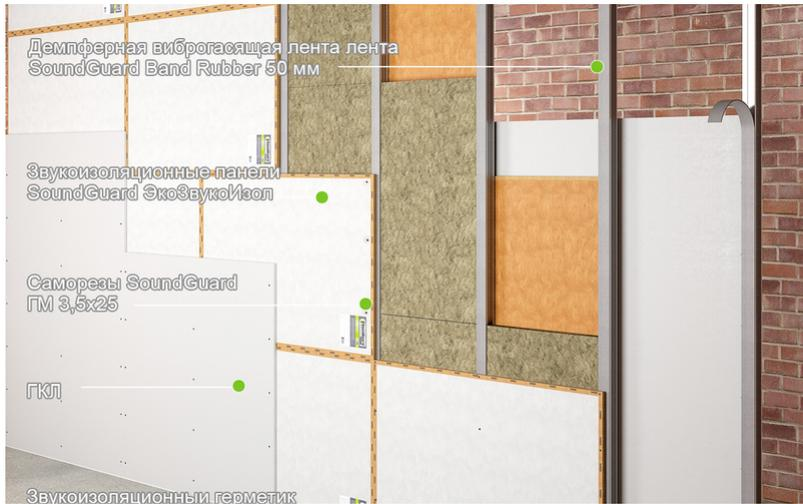
Звукоизоляция перегородки из гипсокартона "Премиум"
