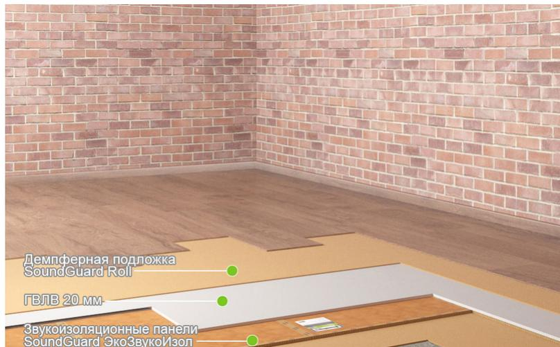
звукоизоляция пола в квартире- система "Стандарт+"
