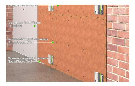
Бескаркасная звукоизоляция стены - "Эконом" RW = 55-58 дБ
