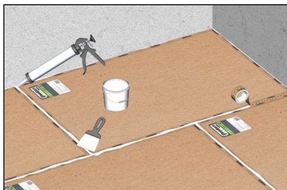
**4** Между финишным покрытием пола и стеной необходимо оставить зазор величиной 4 мм, который нужно заполнить герметиком **SoundGuard Seal**.
