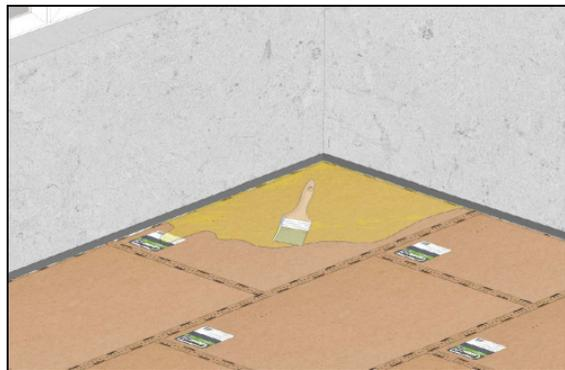
**4b** После просушки на панели **SoundGuard** монтируется армированная стеклосеткой стяжка из пластичного плиточного клея толщиной не менее 6 мм.
