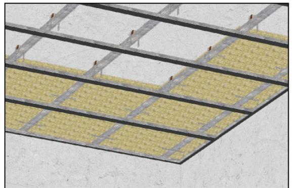
**7** Саморезами ГМ 3,5×25 к каркасу крепятся звукоизоляционные панели **SoundGuard**. Каркас обшивается панелями вразбежку по отношению к предыдущему ряду, вплотную к стенам.
