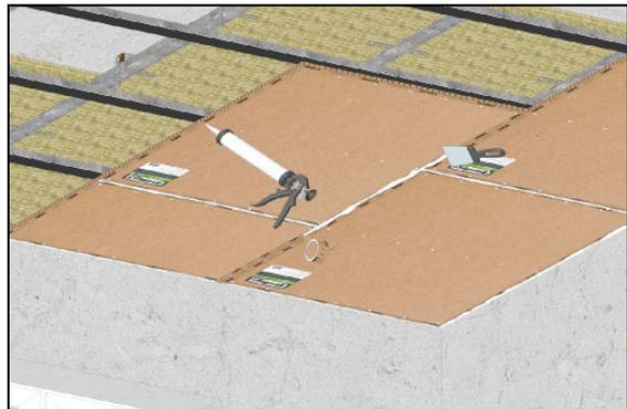
**9** Финишная облицовка конструкции производится двумя слоями: первый слой из гипсоволокнистого или гипсокартонного листа, второй – из гипсокартонного листа. Первый облицовочный лист крепится саморезами ГМ 3,5×35 к профилю каркаса с усилением соединения с помощью точечного нанесения герметика **SoundGuard Seal**.
