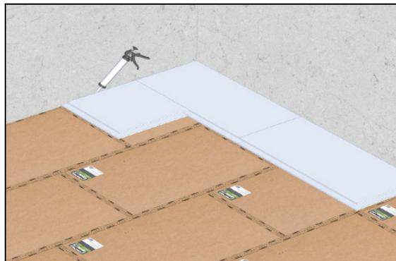
**4а** Кафельная плитка монтируется на подготовленную поверхность согласно рекомендациям производителя плитки. Между кафельной плиткой и стеной необходимо оставить зазор величиной 4 мм, который нужно заполнить герметиком **SoundGuard Seal**.
