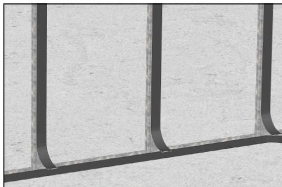
**4** Стоечные профили устанавливаются с шагом 400–600 мм. Внутренняя полость каркаса заполняется звукопоглощающим материалом из линейки **SoundGuard**.
