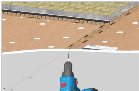
**10** Финишный слой ГКЛ крепится вразбежку саморезами ГМ 3,5×45 к профилю каркаса с усилением соединения с гипсоволокнистым листом при помощи точечного нанесения герметика **SoundGuard Seal**.
