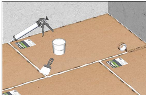
**4** На плиты монтируется плотный материал, такой как KNAUF Суперпол или его аналог. Между предварительным покрытием и стеной необходимо оставить зазор величиной 4 мм, который нужно заполнить герметиком **SoundGuard Seal**.
