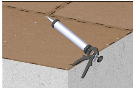
**8** Места стыков панелей между собой и швы примыкания к стенам при помощи шпателя или монтажного пистолета заполняются герметиком **SoundGuard Seal**, желательно не ранее, чем через 24 часа после монтажа. Стыки панелей проклеиваются самоклеющейся лентой **SoundGuard Tape**.
