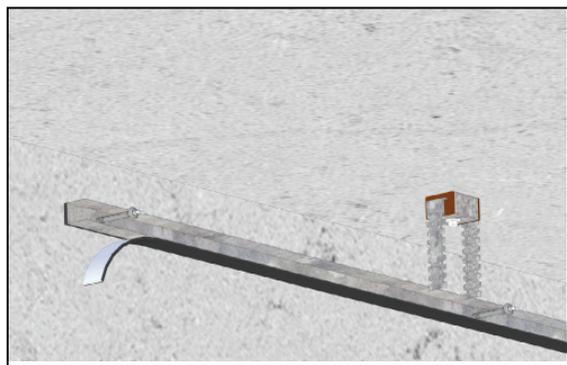
**3** Боковая стенка направляющего профиля проклеивается демпферной лентой **SoundGuard**. Первый уровень потолочных профилей устанавливается с шагом 600 мм поверх направляющих профилей и скрепляется саморезом.
