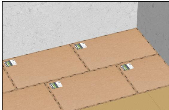
**3** Швы между панелями и стыки со стенами заполняются герметиком **SoundGuard Seal** и проклеиваются самоклеющейся лентой **SoundGuard Tape**. Ламинат и паркетная доска системы монтируются непосредственно на панели **SoundGuard** либо в соответствии с рекомендациями производителя.
