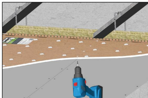
**10** Финишный слой ГКЛ крепится вразбежку саморезами ГМ 3,5 × 45 к профилю каркаса с усилением соединения к гипсоволокнистому листу при помощи точечного нанесения герметика **SoundGuard Seal**.
