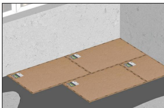
**2** После высыхания клея швы между панелями и стенами заполняются герметиком **SoundGuard Seal**. Стыки между панелями заполняются герметиком **SoundGuard Seal** и проклеиваются самоклеющейся лентой **SoundGuard Tape**.
