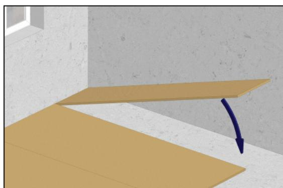
**1c** На пол укладывается полотно **SoundGuard Roll**, поверх него укладывается мягкая ДВП толщиной 10–12 мм.
