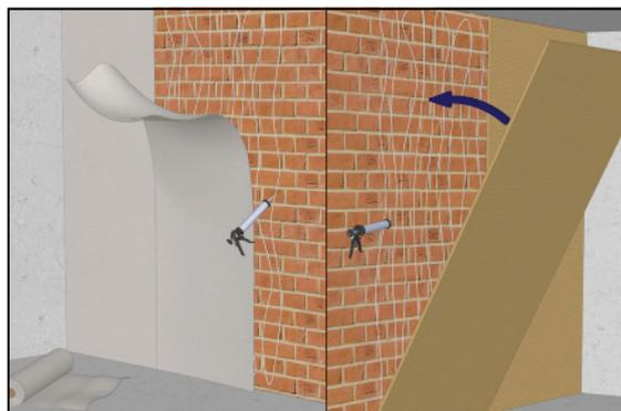
**2** Звукоизоляционные панели крепятся к стене через установленную демпфирующую прослойку с помощью акустических дюбелей **SoundGuard DA-P**, которые забиваются в предварительно просверленные через панель в стене отверстия.
