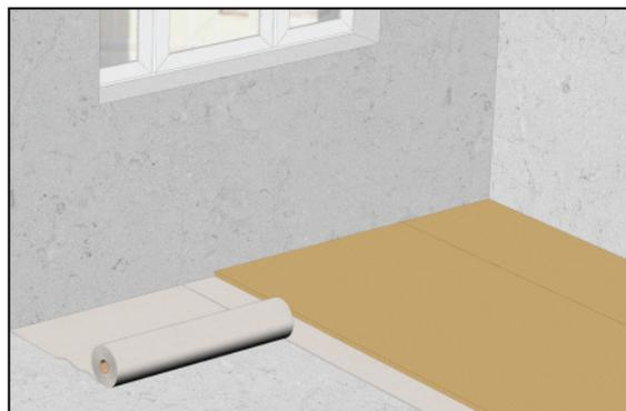
**2** Поверх демпферной подложки укладываются звукоизоляционные панели **SoundGuard**, кромка к кромке, впритык к стенам, вразбежку, без зазоров.
