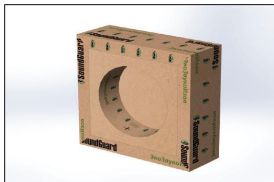
**11** Отверстие под гнездо вырезается заранее в горизонтально расположенной панели, край спила обрабатывается герметиком **SoundGuard Seal** или клеится самоклеющейся лентой **SoundGuard Tape**.
