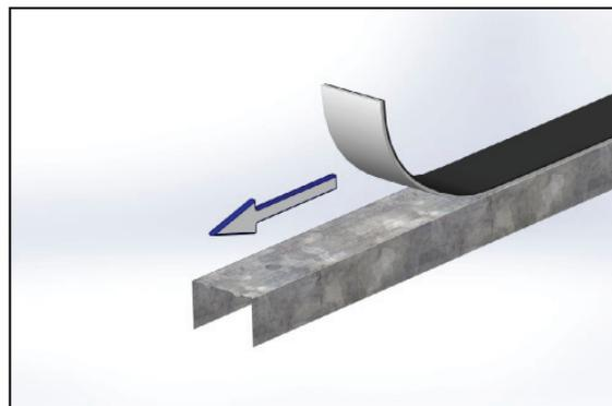
**3** Для уменьшения передачи структурного шума в точках крепления направляющего профиля применяется виброразвязывающая шайба **SoundGuard Vibro Washer 8 x 18** с шагом 600 мм. При использовании виброразвязывающей шайбы диаметр отверстия в профиле под дюбель-гвоздь должен быть 10 мм. Боковая стенка направляющего профиля проклеивается демпферной лентой **SoundGuard**.
