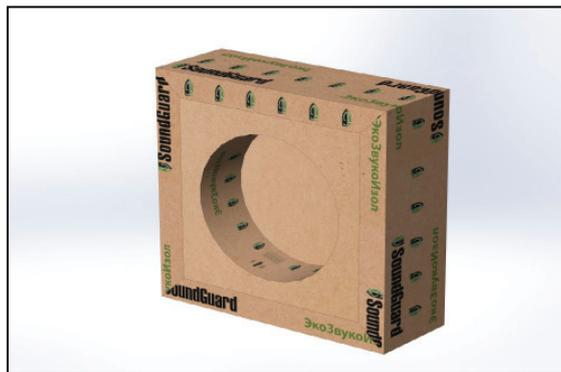
**11** Отверстие под гнездо вырезается заранее в горизонтально расположенной панели, край спила обрабатывается герметиком **SoundGuard Seal** или клеивается самоклеющейся лентой **SoundGuard Tape**.
