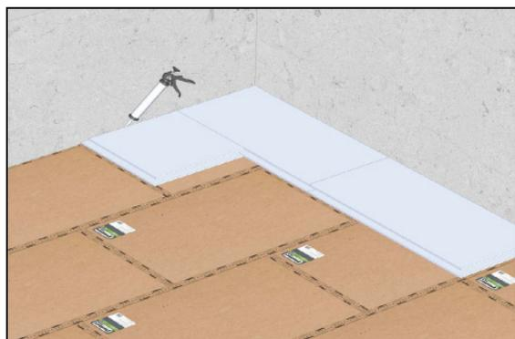
**5** На подготовленную поверхность укладывается линолеум или ковролин в соответствии с рекомендациями производителя.
