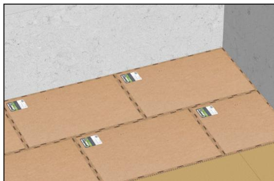
**3** Швы между панелями и стенами заполняются герметиком **SoundGuard Seal**, а стыки между панелями заполняются герметиком **SoundGuard Seal** и проклеиваются самоклеющейся лентой **SoundGuard Tape**.
