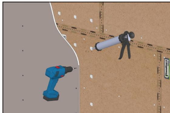
**9** Финишный слой крепится универсальными саморезами 5×45 к гипсоволокнистому листу с усилением соединения при помощи точечного нанесения герметика **SoundGuard Seal**. При этом важно избегать попадания саморезов в металлический каркас конструкции.
