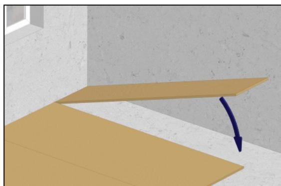
**2** Поверх демпферной прослойки укладываются панели **SoundGuard**, кромка к кромке, впритык к стенам, вразбежку, без зазоров.
