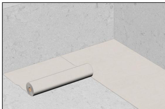
**1b** На пол укладывается мягкая ДВП толщиной 10–12 мм.
