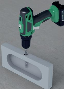
В подрозетнике SoundGuard ИзоБокс Стандарт просверливается отверстие для выпуска проводов. Место выхода электропровода заполняется герметиком SoundGuard Seal.
