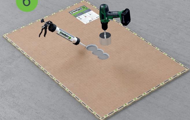
Отверстие под гнездо розетки или выключателя вырезается заранее в горизонтально расположенной панели SoundGuard ЭкоЖвукоИзол и промазывается виброакустическим герметиком SoundGuard Seal.
