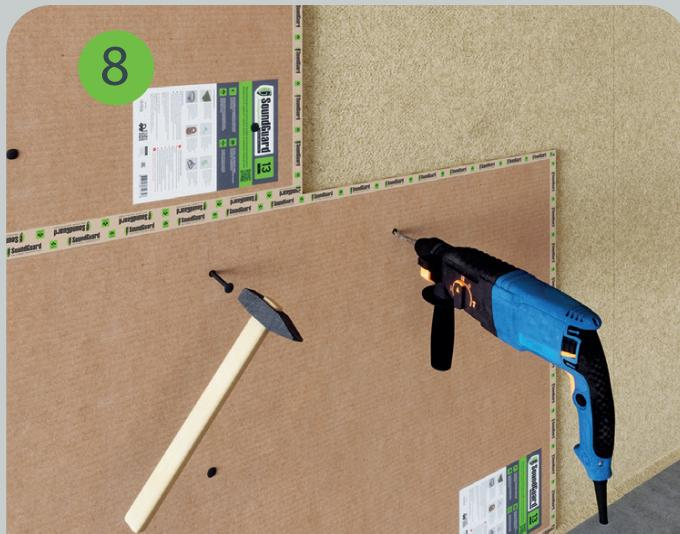
Акустические дюбель-гвозди забиваются в предварительно просверленные (сквозь панель) отверстия в стене и утапливаются в тело панели на 1 мм. На одну звукоизоляционную панель требуется не менее 12 дюбель-гвоздей SoundGuard DA-P.
