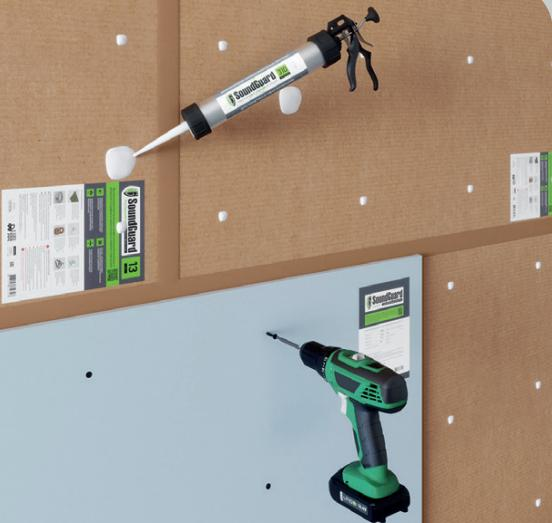
Звукоизоляционный гипсокартон Gipsofon ПЛУК крепится к поверхности панелей саморезами SoundGuard ГП 3,9x25 с усилением соединения при помощи точечного нанесения герметика SoundGuard Seal.
