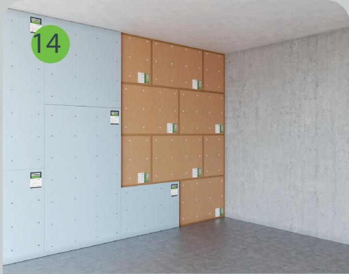
Звукоизоляционный гипсокартон Gipsofon ПЛУК монтируется без зазоров между листами. Расход саморезов SoundGuard ГП 3,9x25 не менее 22 шт./м<sup>2</sup>.
